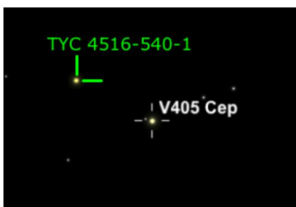
TYC 4516-540-1 mit 9.51 mag ist nur 49 Bogensekunden von V0405 Cep entfernt. Mit dem Setup (Kamera ASI 120 | Objektiv 50mm F1.8) beträgt die Auflösung am Himmel 15 Bogensekunden. Der Abstand ist mit ca. 3 Pixel zu klein, um V0405 Cep separat zu messen. Die gemessene Helligkeit ist die Summe beider Sterne.
